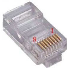
Рис.4. Контакты разъема RS-485 на стороне контроллера BMS
